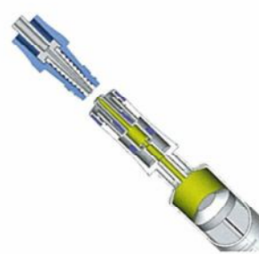
外れた状態のときは必ず閉鎖される
